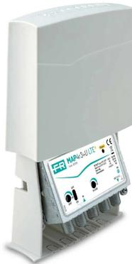
Amplificatore con 1 ingresso (UHF) da palo con guadagno 30dB e livello di uscita fino a 118dB $\mu$ V in banda UHF, regolazione del guadagno 0-15dB e bassa figura di rumore. Filtro 694MHz 5G e 4G LTE integrato.
